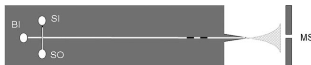
Abbildung 1. Mikrofluidischer Glas-Chip mit integriertem Nanospray-Emitter. SO: Probenausgangsgefäß, SI: Probeneinlassgefäß, BI: Puffereinlassgefäß, MS: Einlass des Massenspektrometers.
